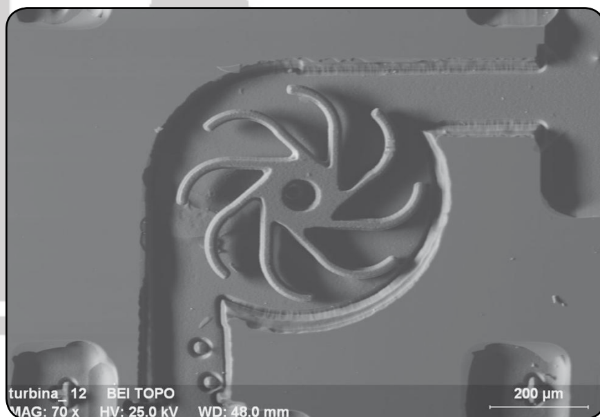
2. ábra Működőképes szilícium mikroturbina
